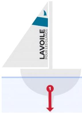
En fonction de la répartition des masses (donc notamment où est stocké le vin dans les cales) s'exerce une force en un point : le **Centre de Gravité** (en 1 sur le schéma). C'est une force verticale, elle joue sur le fait que le bateau s'enfonce plus ou moins.
